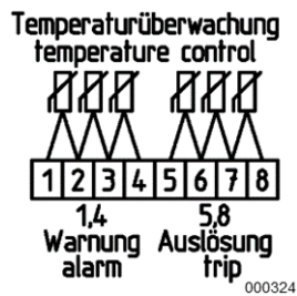
Fig. 5 Eksempel på klemkonfiguration ved standardudførelse af temperaturovervågningen
