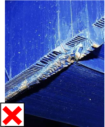
Fig. 12: Ikke tilladt! Kernespidserne på dette åg er kraftigt bøje og berører hinanden
